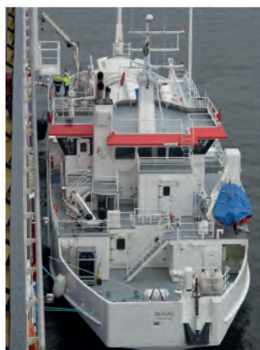
Figure 8: Ship-to-ship LNG bunkering from the LNG bunker barge SEAGAS to VIKING GRACE
